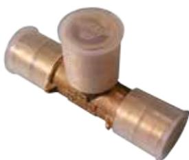
Para garantizar el perfecto estado de los accesorios de latón y válvulas del sistema AC-FIX ANILLO PLÁSTICO DE EXPANSIÓN, todas sus tetinas se suministran cubiertas por un capuchón protector, evitando así posibles desperfectos durante su manipulación. En el mismo capuchón, aparece marcado el diámetro de la pieza para una rápida identificación.
