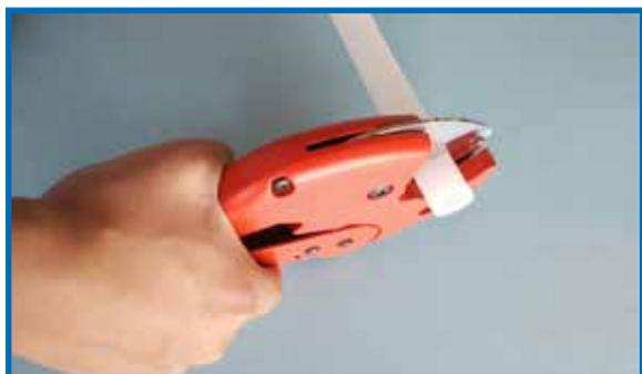
1. Es muy importante cortar el tubo de manera limpia y perpendicular a su eje. El extremo de la tubería deberá estar seco y exento de grasa, a fin de que el anillo de plástico no se deslice por la tubería al expandirla.
