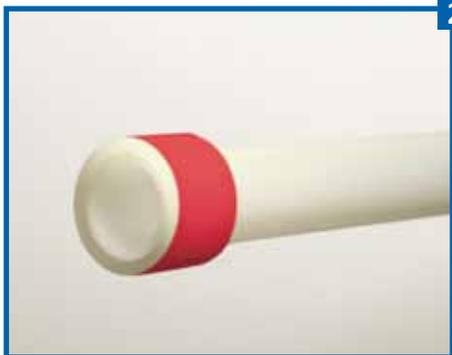
Colocar el anillo de plástico en el extremo de la tubería de forma que el extremo del anillo sobresalga un poco (máx. 1mm) respecto a la tubería. El anillo de plástico debe estar bien ajustado. Si queda suelto, meterlo unos centímetros en la tubería y expandir un poco el extremo de ésta sin el anillo de plástico. Después, volver a colocar el anillo de plástico en el extremo de la tubería.
