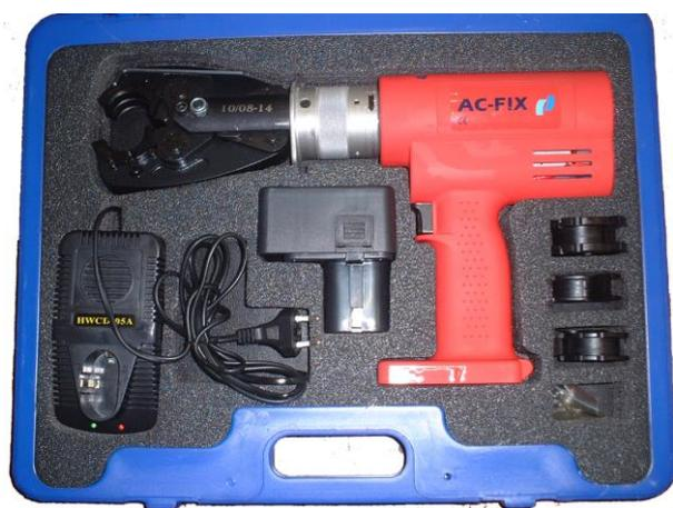
泡沫成形的塑料盒内装有卡压工具, 四套U或RF夹头, 或是三套TH夹头, 电池和充电器。
