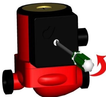
4. 稍微拧松泵右侧的螺丝。**警告：不要拧下来。**电线从螺帽 2 的孔内穿入（如图 1）。
