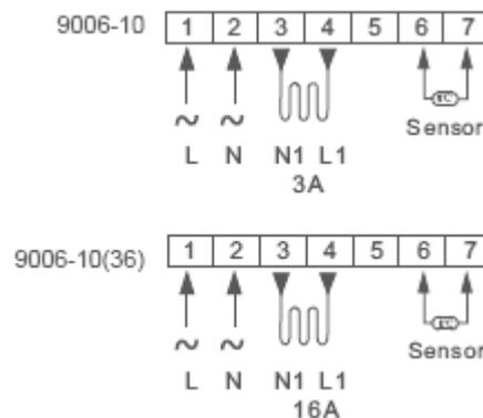
Le capteur (sonde) du sol se branche aux terminals 6 et 7.
