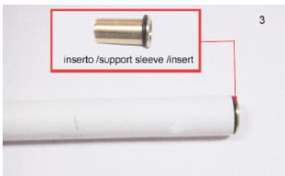
3. Introduzca el inserto dentro en la extremidad del tubo. Hay que utilizar el inserto correspondiente al DN del tubo, tenga cuidado de utilizar el inserto correcto.
