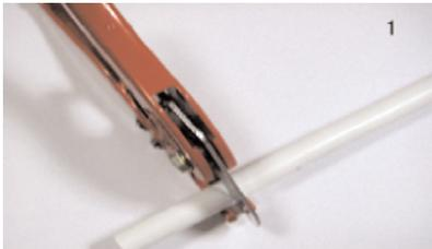
1. Corte el tubo de manera limpia y perpendicular a su eje.
