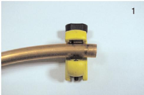
1. Corte el tubo de manera limpia y perpendicular a su eje.
