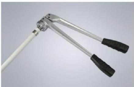
2 在管材一端插入铜环后扩管。
