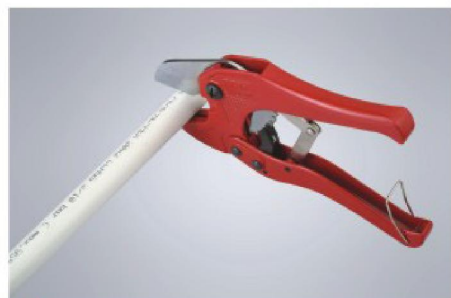
1 切管。切口须垂直于管子的轴心。
