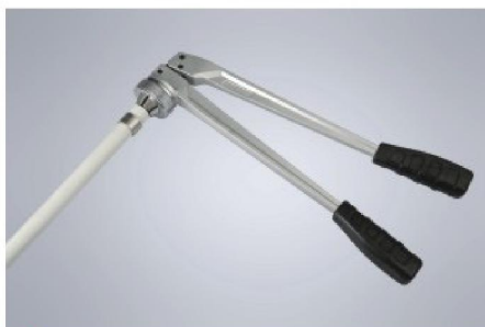
2 在管材一端插入铜环后扩管。
